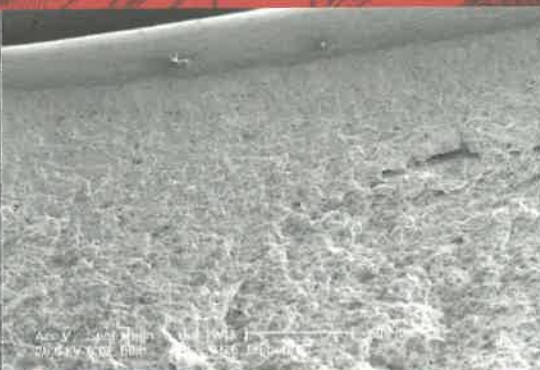
Zonas C de la probeta L analizadas las cuales se obtiene un tipo de fractura dúctil.
