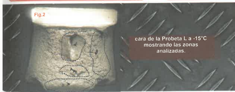
Zona D se muestra un tipo de fractura dúctil
